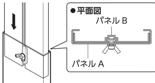
c. パネルを窓枠の高さにあわせます。
