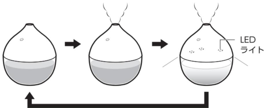
※充電電池の残量が少なくなるとLEDライトが点滅し、残量が無くなると消灯します。
