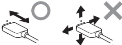
無理に接続したり、接続したまま上下左右に動かしたりすると、接続部の破損や故障の原因になります。
