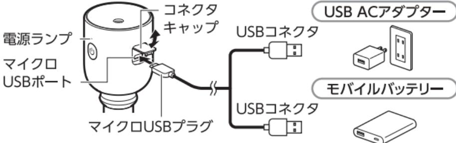
④ 充電完了後、マイクロUSBケーブルを取り外します。
