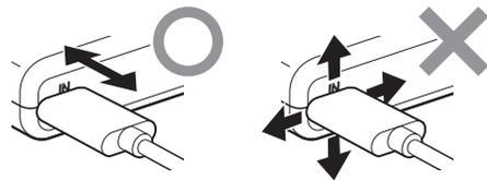
① バッテリーパックのマイクロUSBポートにマイクロUSBプラグを接続します。
