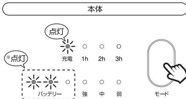
※ 電池残量に応じた『バッテリー』ランプが点灯します。
